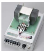
アモルファス帯磁気測定枠 試料サイズ：15mm x 100mm
