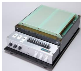
アモルファス帯磁気測定枠 (SK3316) IEC 60404-16準拠枠
